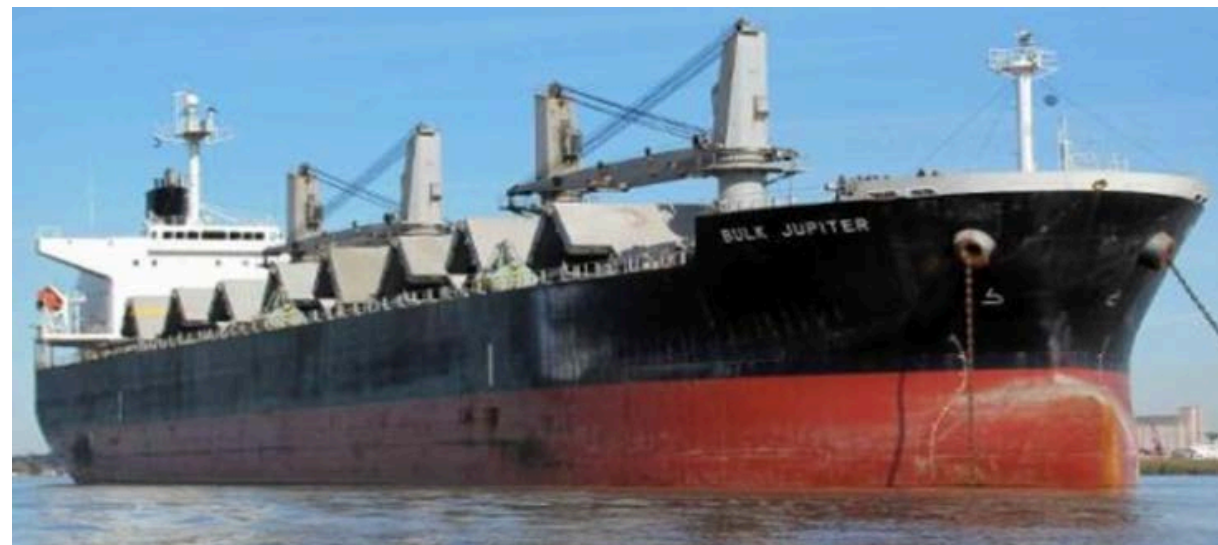
Le "Bulk Jupiter, minéralier de 50.000 tonnes, perdu, corps et biens en 2015 sous l'effet de carène liquide
