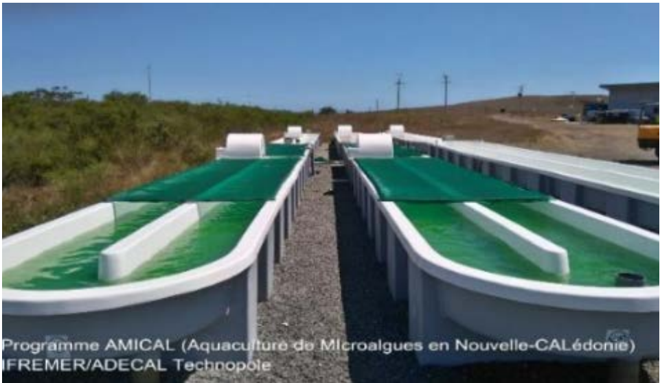
Essai de production en raceway au Laboratoire Technologique des MicroAlgues (LTMA) à Koné
