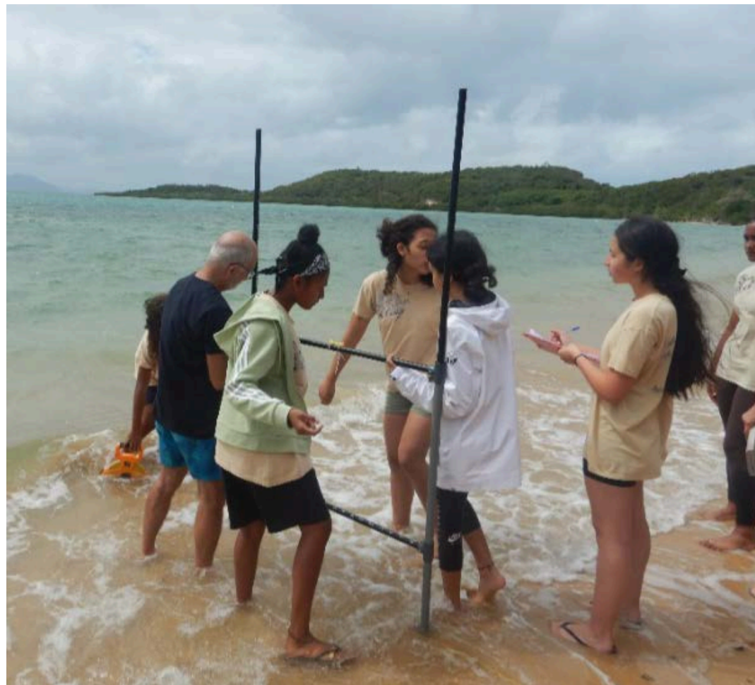
Mise en œuvre d'un cadre topomètre sur un profil de plage à l'îlot Bailly
