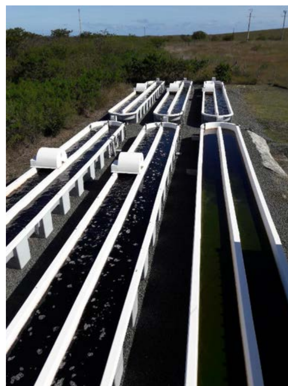
Plateforme de production de microalgues en raceway au Laboratoire Technologique des MicroAlgues (LTMA) à Koné
