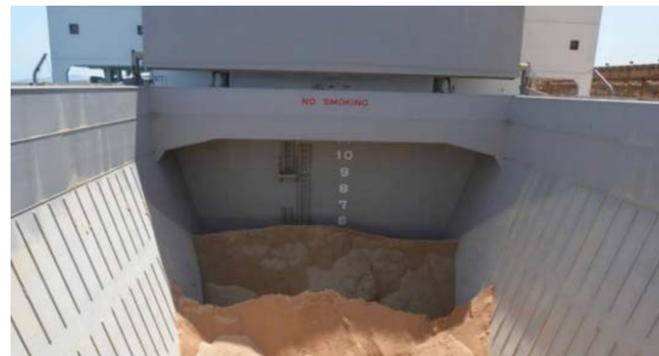
Les cales de l'Amborella présentant la disposition « anti carène liquide » : étroitesse, pente importante des parois, ballasts.
